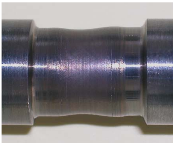
Teljesen átheszített anyag középső részének képe
