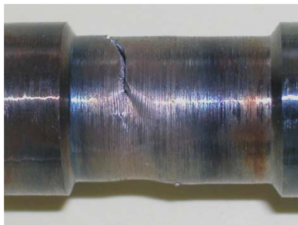
Teljesen átheszített anyag középső részének képe a felgyorsított kúszási teszt után
